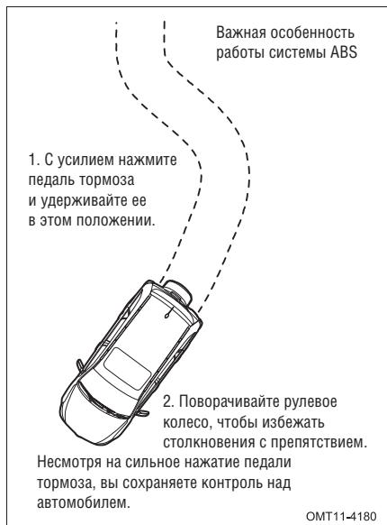
Антиблокировочная система (ABS) срабатывает немедленно при резком торможении; при этом сохраняются тормозные качества и управляемость автомобиля. При достаточном расстоянии до препятствий вы даже сможете объехать их.
