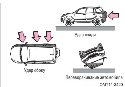
Фронтальные подушки безопасности обычно не срабатывают при ударе сбоку или сзади, переворачивании или фронтальном столкновении с небольшой скоростью. Но, всякий раз, когда столкновение любого типа вызывает достаточное продольное замедление автомобиля, фронтальные подушки безопасности могут сработать.
