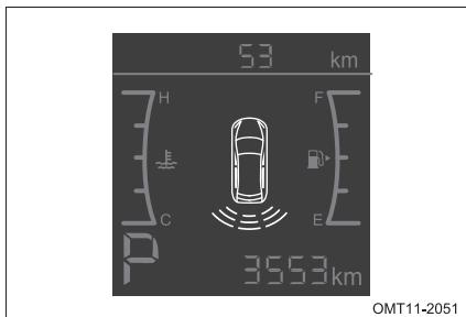
Если замок зажигания находится в положении ON, а рычаг переключения передач или рычаг селектора переведен в положение R (Задний ход), то на многофункциональном дисплее будут отображены данные системы помощи при движении задним ходом.
