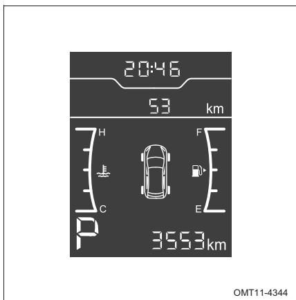
Если давление в какой-либо шине не соответствует норме, на многофункциональном дисплее будет мигать символическое изображение этой шины. В таком случае следует довести давление воздуха вшине до предписанного значения.
