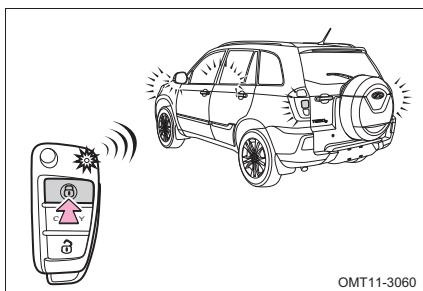
Для запирания замков всех дверей нажмите кнопку запирания на ключе с пультом дистанционного управления. При этом все указатели поворота мигнут один раз, и один раз прозвучит противоугонная сигнализация. Противоугонная система включена.
